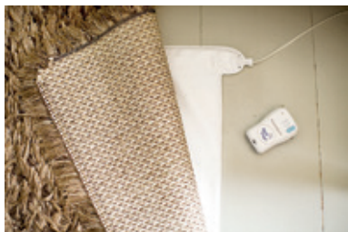
Mattohälytin hälyttää hakulaitteeseen, kun maton päälle astutaan. Hälyttimen voi sijoittaa maton alle, esimerkiksi sängyn viereen tai ulko-oven eteen.
